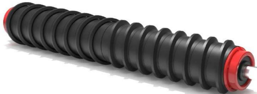
Rodillos fabricados a base de cabezales termosoldables provistos de rodamientos de precisión, con bolas de cromo-níquel ó inoxidable, según necesidades y provistos de aros de goma limpiadores helicoidales.
