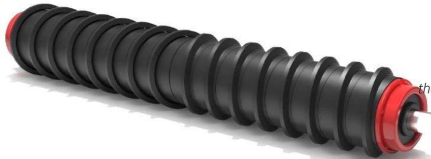
Rouleaux constitués de têtes thermosoudées équipées de roulements de précision, avec billes en chrome-nickel ou inox, selon les besoins et équipées de bagues en caoutchouc de nettoyage hélicoïdales
